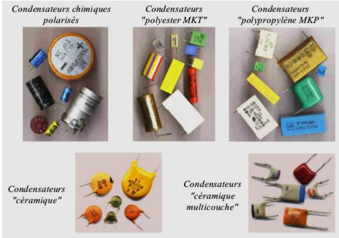
☞ Le condensateur se comporte comme un réservoir d'énergie électrostatique
